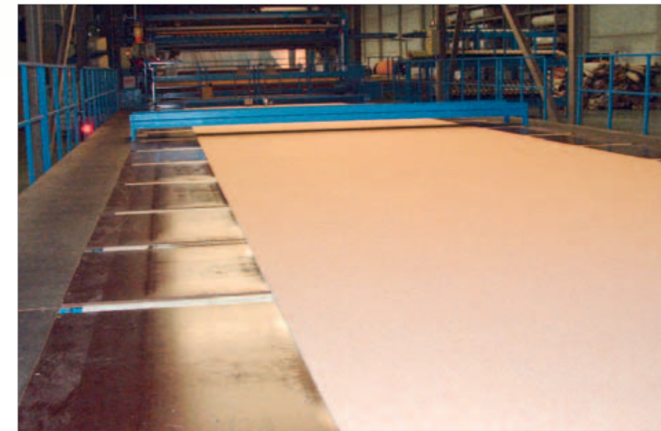
De backingmachine brengt de rug aan op het tapijt
