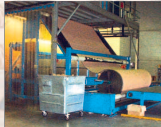
Het oprollen van het gerede tapijt (boven links) Tapijt specimens van verschillende kleuren (boven rechts) Vele spoelen voeden de tuftmachine (onder)
